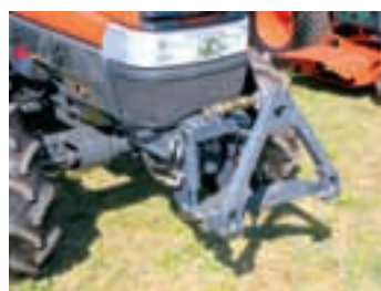
Na přání mohou být všechny traktory Kubota vybavené předním vývodovým hřídelem a čelním návěsem
