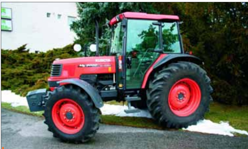
Traktor Kubota ME9000 pracuje s výkonem motoru 95 koní a moderní hydraulicky řízenou reverzní převodovkou
