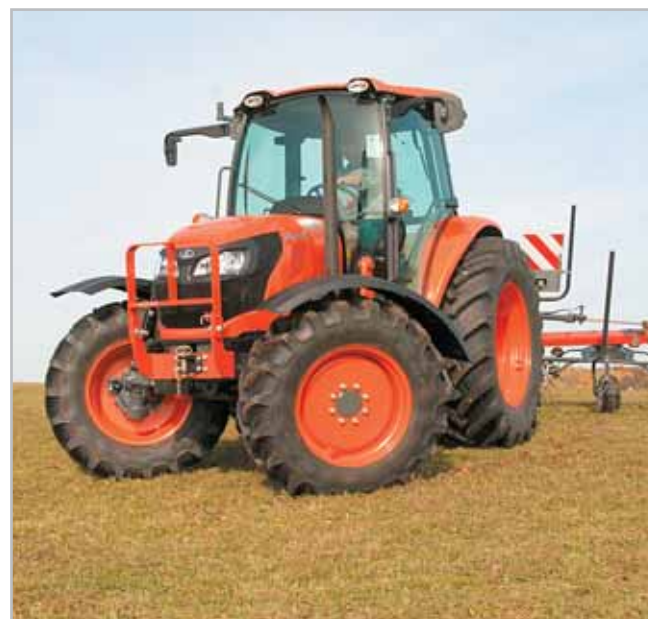
Portálová náprava s úhlem natočení kol až 57° zajišťuje malý poloměr otáčení pouze 4,5 m
