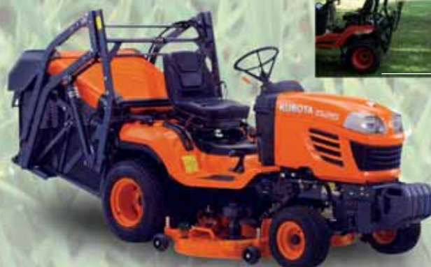
G 26 HD/HD (26 HP) HD – výsyp do výšky 1930 mm
