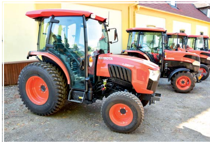
Premiovým strojem je model L2602 s převodovkou powershift, funkcí kontroly přetížení hydrauliky a velmi prostornou a pohodlnou kabinou s automatickou klimatizací Foto Jan Kroupa
