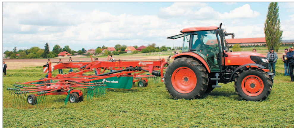
Kubota M9540 při práci se shrnovačem Kverneland TA 9584 s tvorbou středového řádku ze záběru 8,5 metru Foto Vladislav Fuka
