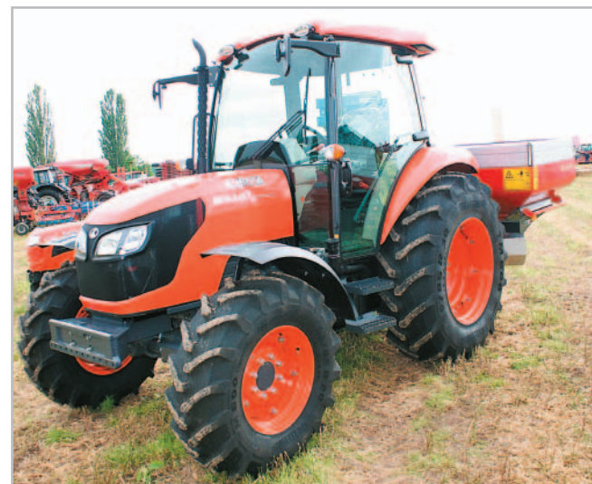
Rozmetadlo minerálních hnojiv nesl v zadním třibodovém závěsu traktor Kubota M6040 Foto Vladislav Fuka
