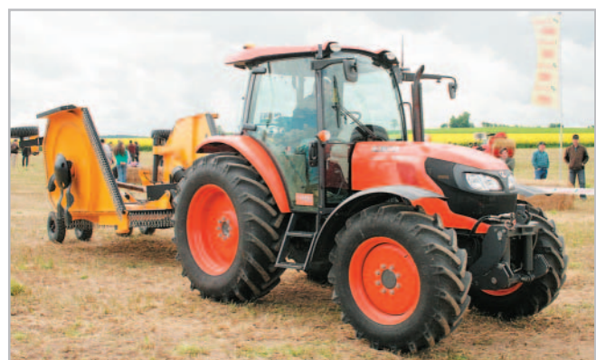
S mulčovačem McConnel SR 460 byl v Bečvárech agregován traktor Kubota M8560 s motorem o výkonu 63,8 kW/85,5 k Foto Vladislav Fuka
