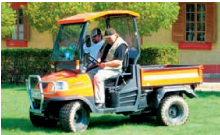
Víceúčelové transportní vozidlo RTV 900 se sklápěcí plošinou
