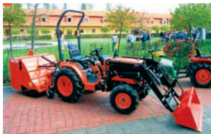
Kubota B 2410 s nakladačem Hydrac a s cepákovou sekačkou Muratori
