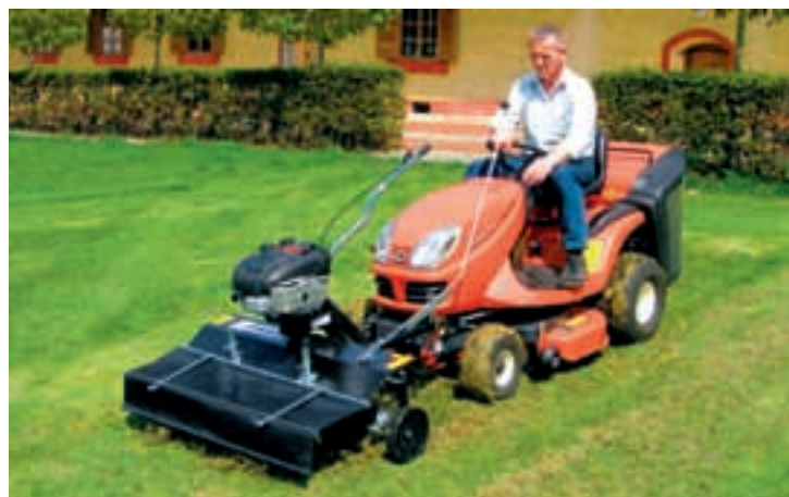
Travní sekačka GR 1600 v agregaci s vertikutátorem
