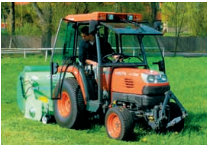
Traktor STV 36 vybavený trávnickými pneumatikami v agregaci s cepákovou sekačkou Peruzzo – Koala se zásobníkem o objemu 1200 l
