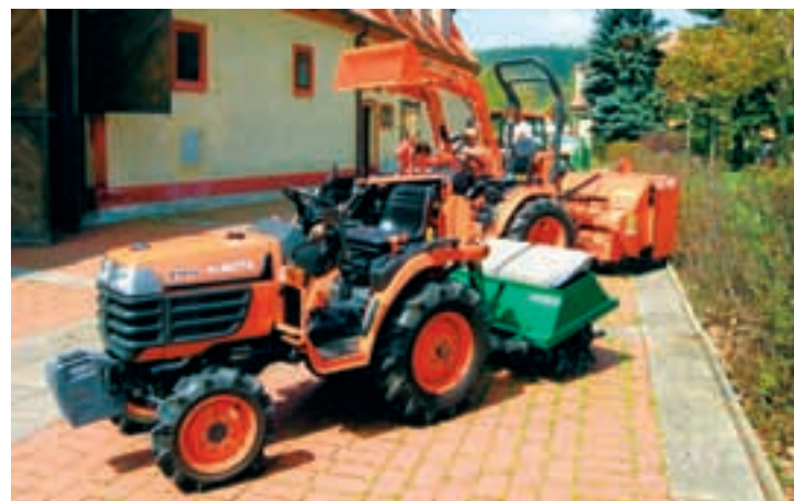
Kompaktní malotraktor B 1410 s návěsným provzdušňovačem Sembdner
