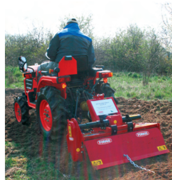
V průběhu předváděcího dne proběhly praktické ukázky účinnosti strojů. Zde rotavátor značky Forigo se čtyřmi noži na hřídeli
