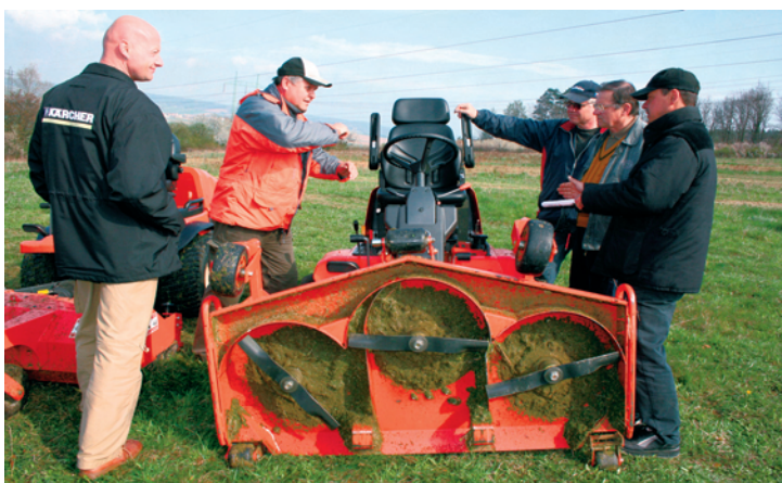
Pro snadnější údržbu a čištění je výhodou možné sklopení žacího ústrojí o 90°
