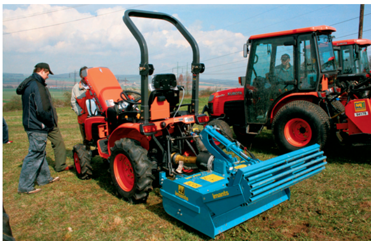
Přídavná zařízení značky Imants zaručují úplnou přípravu půdy do hloubky 50 cm nezbytnou pro následnou výsadbu a výsev dřevin
