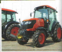
Kromě kompaktních rozměrů je výhodou také patentovaný systém Bi-speed, který pomáhá Kubotě otočit se doslova „na fleku“
