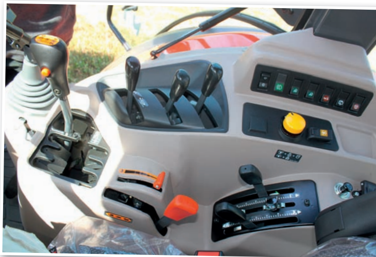
Ovládací prvky traktoru jsou jednoduché, řadící páka má parkovací polohu
