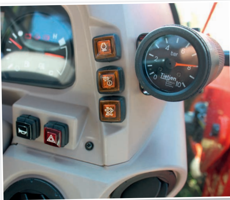
Vedle tlakoměru vzduchu je umístěna trojice tlačítek. Horní je určeno pro nastavení konstantních otáček motoru, středním se spouští manuální, spodním automatická regenerace filtru částic. Vlevo je vidět netradičně umístěné tlačítko houkačky
