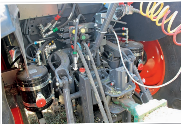
Počet vnější hydraulických okruhů může být od dvou do čtyř, standardem pro ČR jsou dvouhadičové brzdy pro agregované stroje
