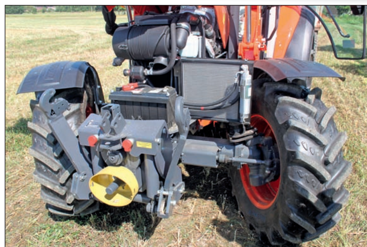
Pro čištění chladičů lze takto vysunout kondenzátor klimatizace
