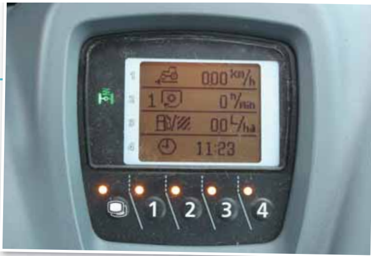
Vedle řadící páky je malý LCD displej zobrazující provozní hodnoty, například hektarovou spotřebu paliva
