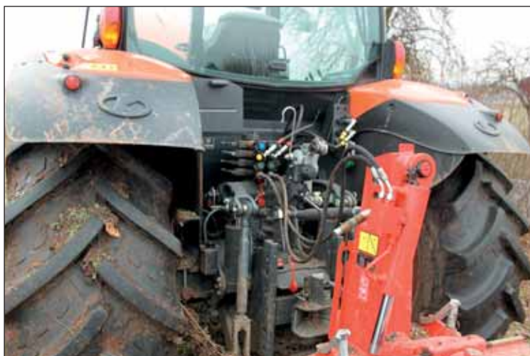
Zadní TBZ se vyznačuje nosností 6,1 t, pro ovládání agregovaných strojů jsou k dispozici dva až čtyři vnější okruhy hydrauliky s mechanickým ovládáním
