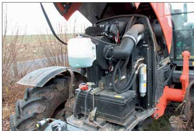
Čtyřválcový motor je zajímavý velkým zdvihovým objemem 6,1 litru
