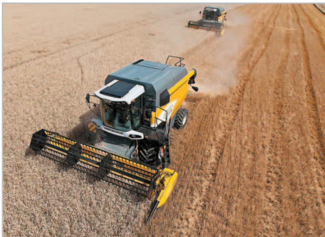
Nová sklízecí mlátička Sampo Rosenlew Comia C12 se může pochlubit motorem o výkonu 300 koní, čtyřmi pracovními bubny, šesti vytrásadly a zásobníkem zrna o objemu 8100 litrů
